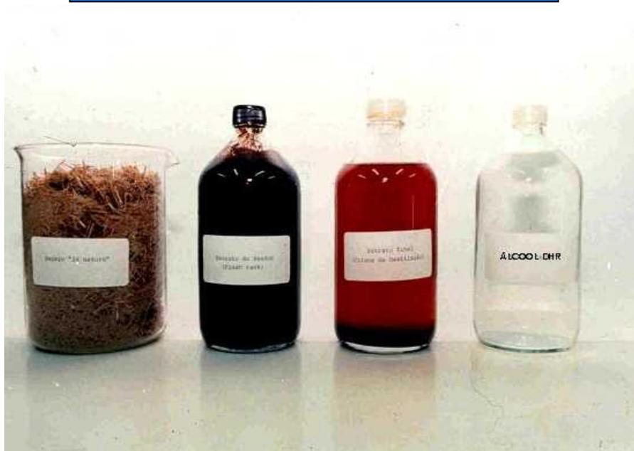
SAMPLE: BAGASSE “IN NATURA”, HYDROLYZED FROM THE REACTOR, HYDROLYZED FROM THE COLUMN OF SOLVENT RECUPERATION; DHR BIOETHANOL.
